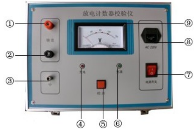
1、2：输出端 3：接地 4、6：充电指示 5：检测键 7：电源开关 8：AC220V插座 9：电压指示
